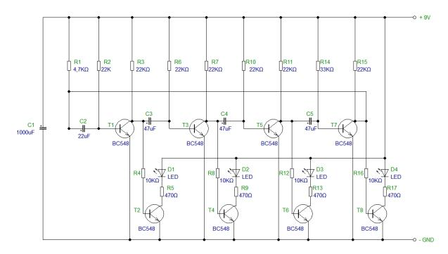
An Autobahnbaustellen sieht man öfters eine sehr auffallende Warneinrichtung, bei welcher ein Lichtblitz über mehrere Lampen hinweg wandert. Auch die sogenannte "Flughafen-Befeuerung" zeigt diesen Effekt. Diese Schalung lässt einen Lichtblitz über 4 LEDs hinweg wandern.
